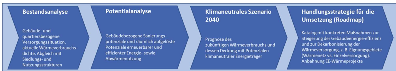
Abbildung 1: Übersicht über die Arbeitsschritte der KWP
