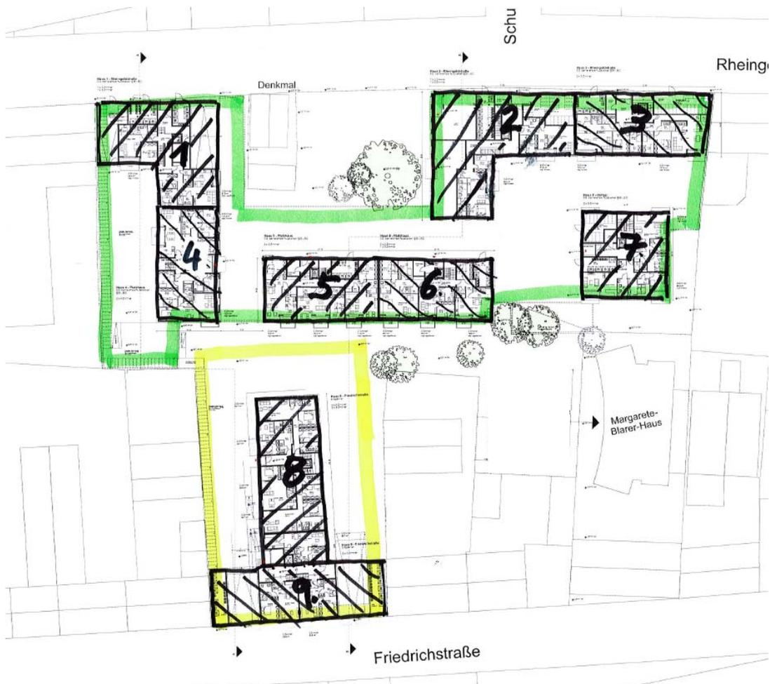
Abbildung 1: Lageplan Gebäude mit Tiefgaragen/Unterkellerung
