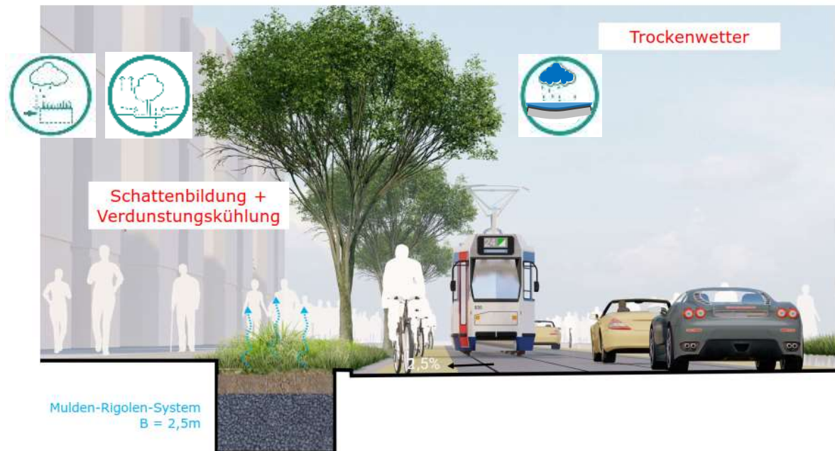
Abbildung 22 Straßenbegleitende Mulden-Rigolen-Elemente (RSD)
