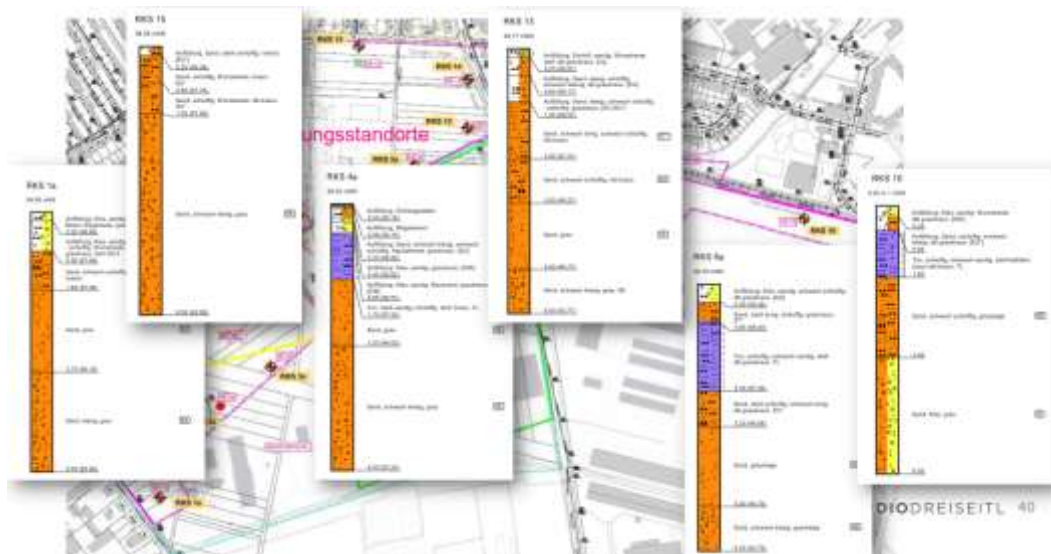
Abbildung 9 Auszug der Bohrprofile aus dem Versickerungsgutachten (IBES 9.8.2019)
