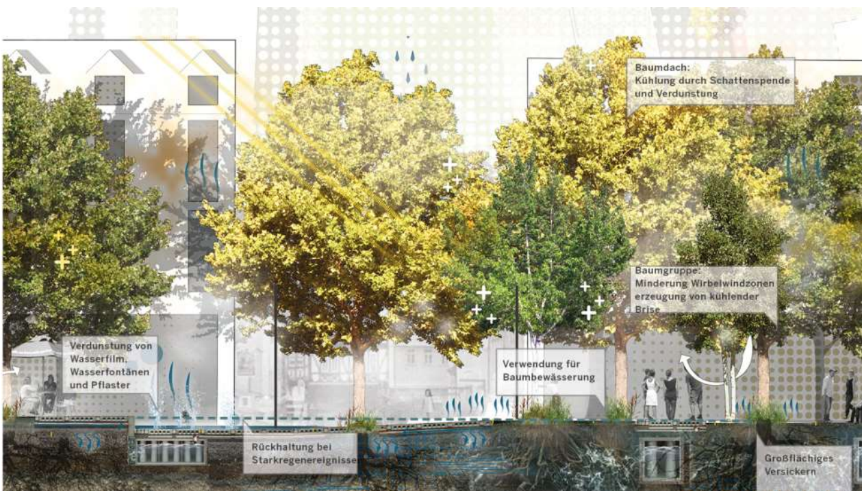
Abbildung 1 Integrierte Gestaltung mit Regenwasser am Quartiersplatz (RSD)
