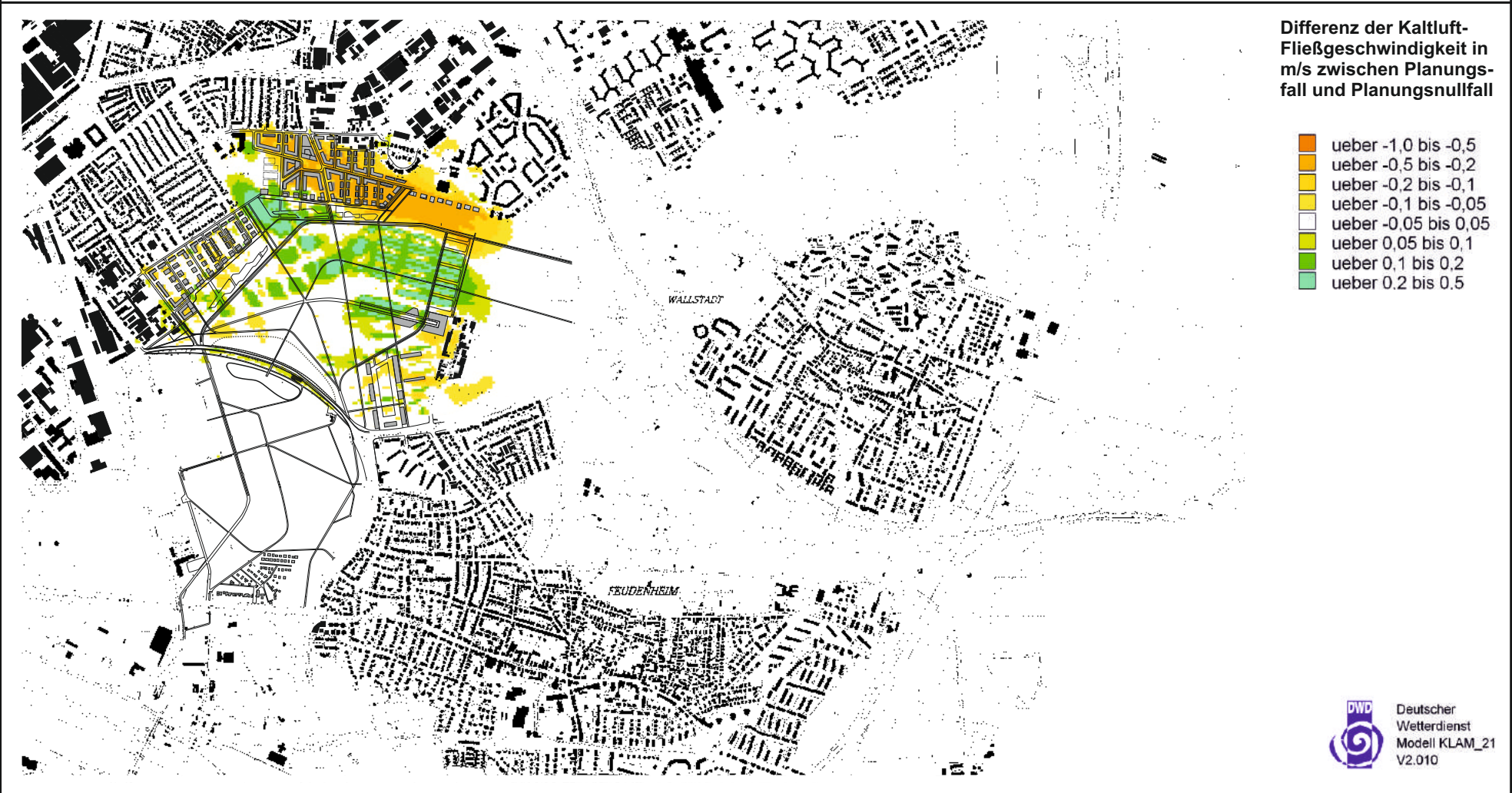
Abb. 6.2 Planungsfall / Kaltluftbewegungen (02:00 Uhr) - Differenz der Kaltluft-Fließgeschwindigkeit (Schichtmittel 0 - 4 m ü.G.) zum Planungsnullfall in einer windschwachen Strahlungsnacht. Ergebnisse mesoskaliger Modellrechnungen
