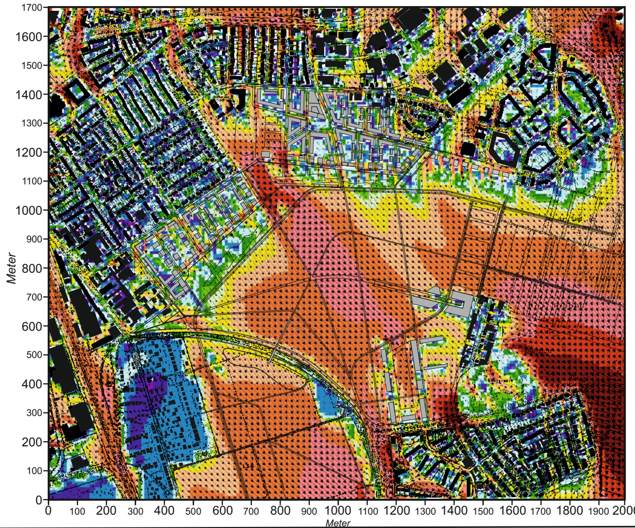
Abb. 10.1 Planungsfall - Belüftungsverhältnisse 2 m ü.G., Windanströmung aus Nordnordwesten mit 2.0 m/s in einer Höhe von 10 m ü.G.
