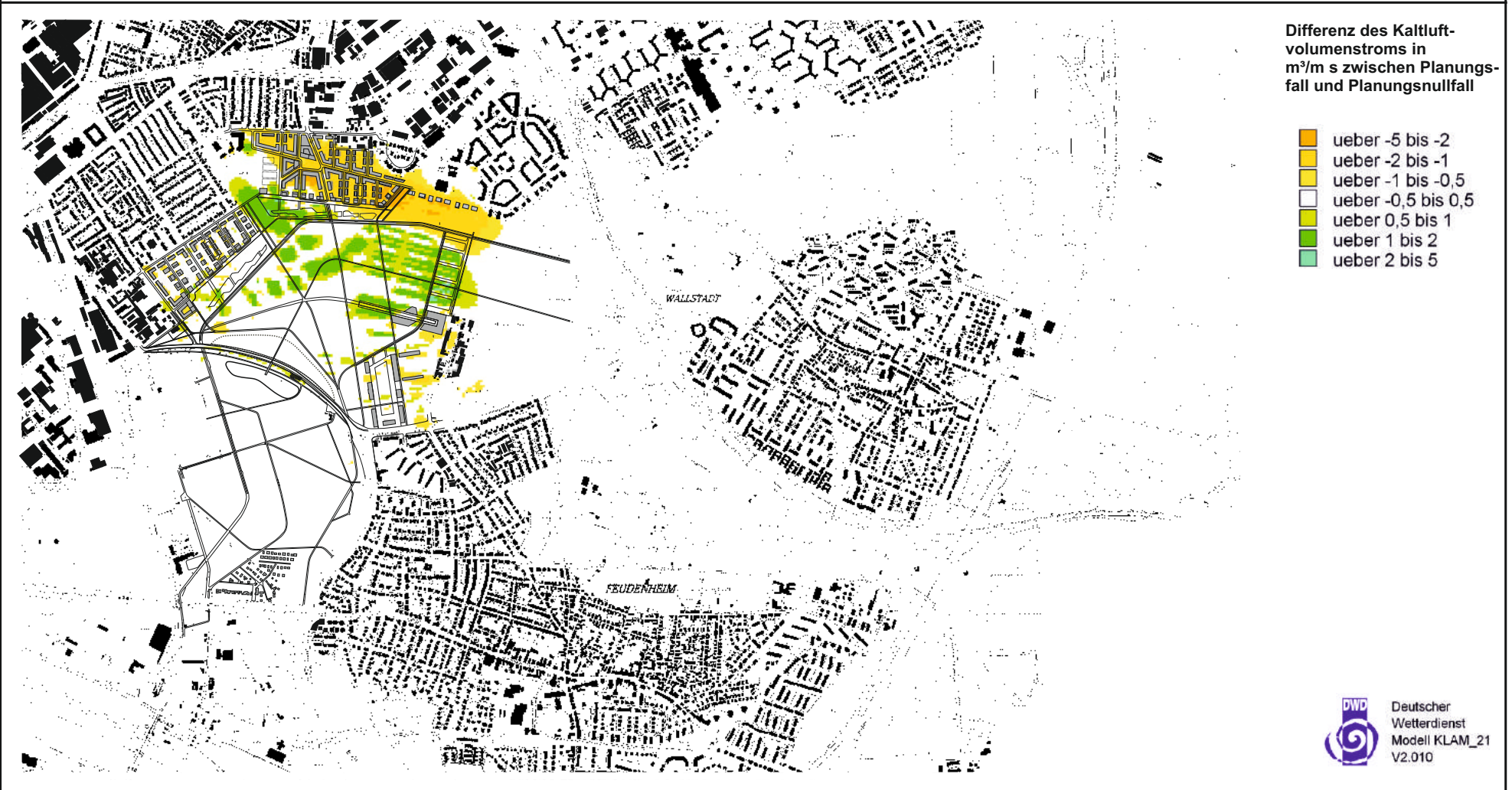
Abb. 6.4 Planungsfall / Kaltluftbewegungen (02:00 Uhr) - Differenz des Kaltluft-Volumenstroms zum Planungsnullfall in einer windschwachen Strahlungsnacht. Ergebnisse mesoskaliger Modellrechnungen
