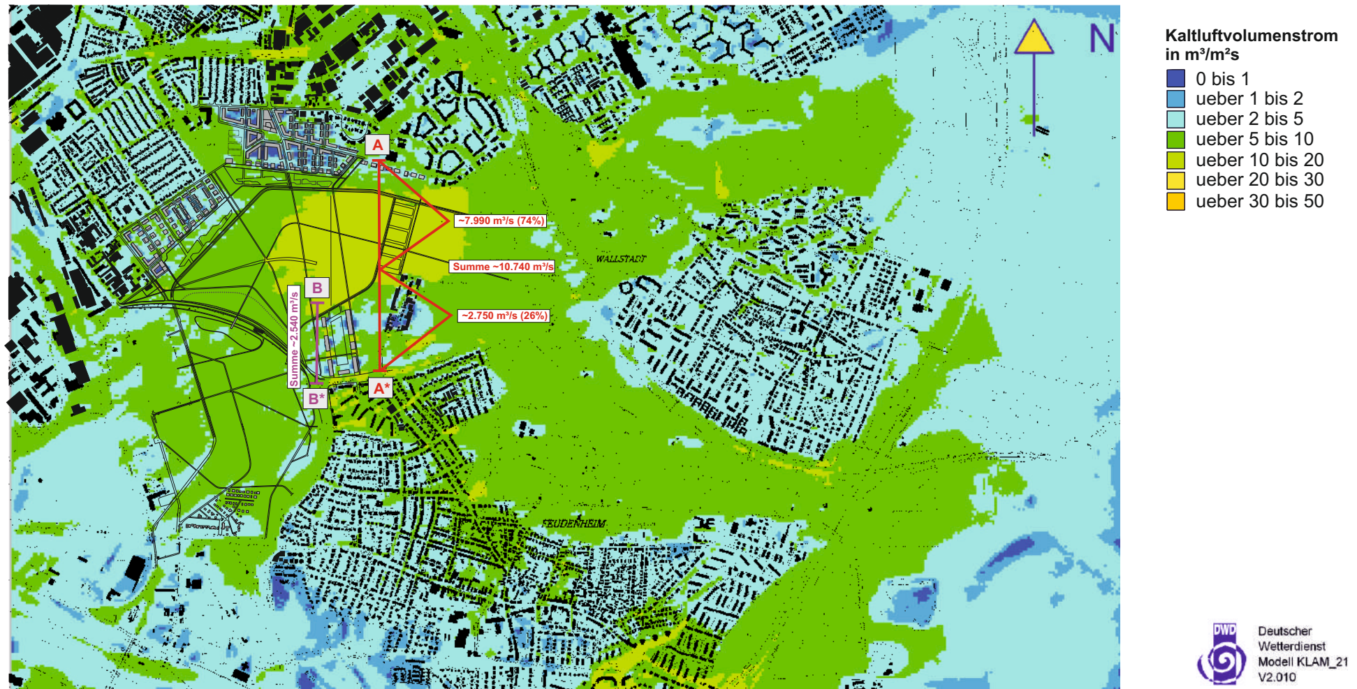
Abb. 19.3 Planungsfall - Variante ohne U-Hallenfragmente und Grünhof / Kaltluftbewegungen (02:00 Uhr) - Kaltluft-Volumenstrom in einer windschwachen Strahlungsnacht. Ergebnisse mesoskaliger Modellrechnungen
